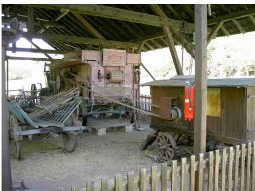
Dreschmaschine mit Elektrobetrieb und Transmission.<sup>9</sup>
