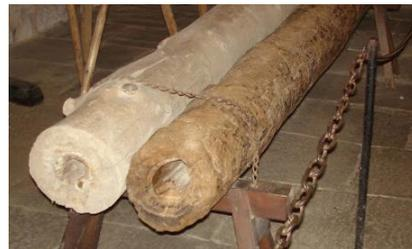
Wasserrohre aus Holz, sogenannte Deischeln.<sup>24</sup>
